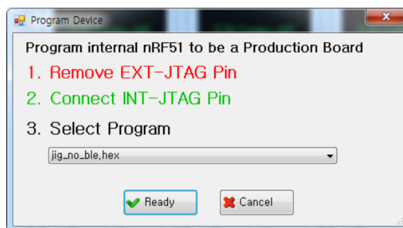
<그림 15. 프로그래머로 사용하기 위해 내부 nRF51 프로그램>
